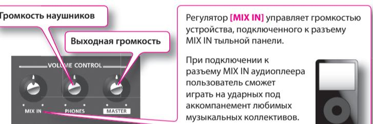
Регулятор [MIX IN] управляет громкостью устройства, подключенного к разъему MIX IN тыльной панели.
